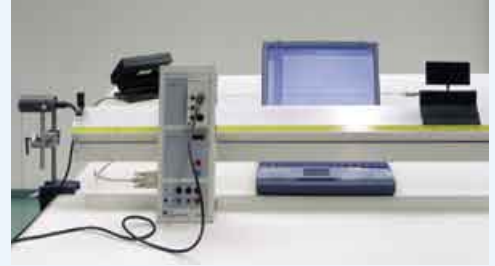
B1 Gleiter auf Luftkissenfahrbahn
