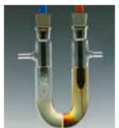
B5 Elektrolyse von Zinkiodidlösung
