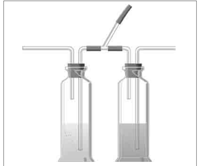
Versuchsaufbau zum Nachweis von CO 2 in der Atemluft
